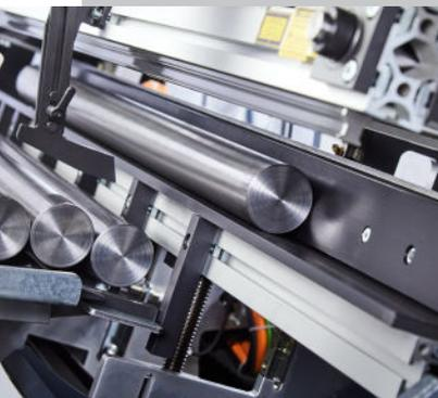
Durchgängig ausgeführte „V-Rinne“ zur effizienten Zuführung auch von kurzen Stangenabschnitten.
