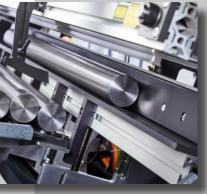
Durchgängig ausgeführte "V-Rinne" zur effizienten Zuführung auch von kurzen Stangenabschnitten
