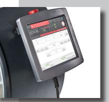
Mobiles Bedientableau mit integrierten Magnethaltern zur flexiblen Befestigung in der Arbeitsumgebung des Bedieners
